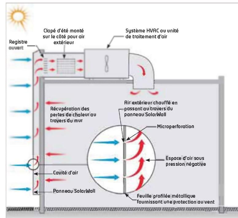
Figure 1 : Photographie (à gauche) et schématisation du fonctionnement (à droite) du système de chauffage solaire SolarWall® installé sur le site TMMF d'Onnaing. Sources : [www.toyota-valenciennes.com](http://www.toyota-valenciennes.com) et [www.solarwall.com](http://www.solarwall.com).
